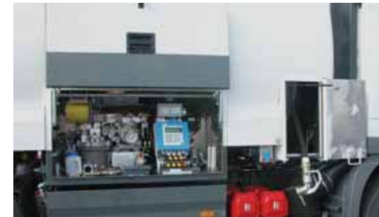
Tankfahrzeug mit bedienerfreundlichem im Tank integrierten Armaturenschrank sowie integrierte Radialschlauchtrommel.
