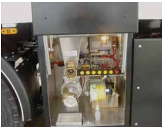
Schwerkraft-Abgabearmatur ungemessen mit Abfüllsicherung und Gaspendelanschluss.
