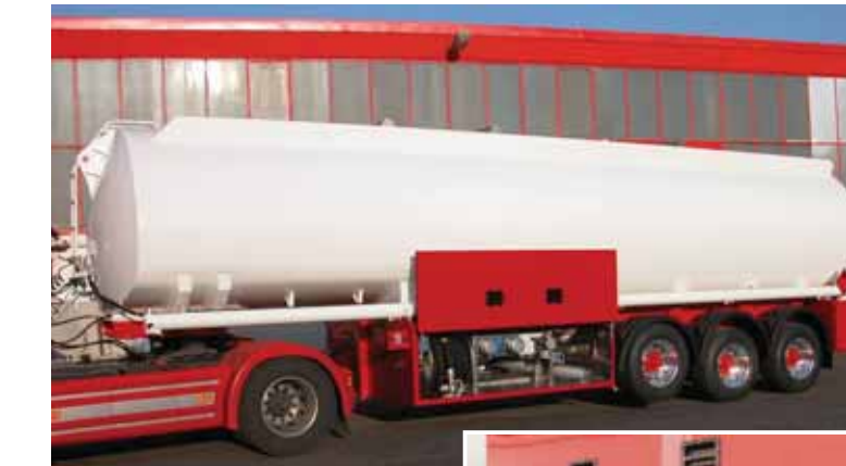
Tanksattelaufleger TSA 40 LTD zum Transport für Heizöl/Diesel und Raps/Sojaöl mit getrennter Messtechnik.
