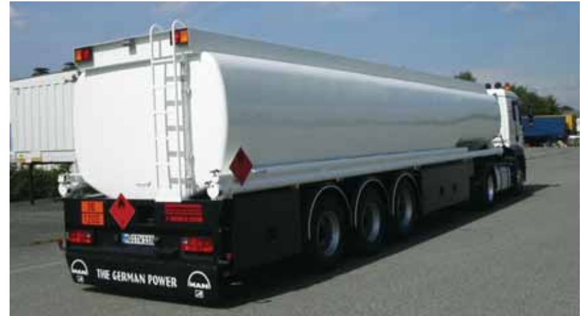
Abgabeseite eines TSA mit elektronischem Peilstabsystem - 6-kammrig.
