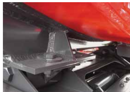
Patentierte vollelastische – Sahara erprobte – Gummilagerung.
