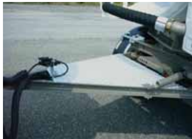
In der Seitenblende integrierte bedienerfreundliche Lagerung des Anhängerverbindungsschlauches.
