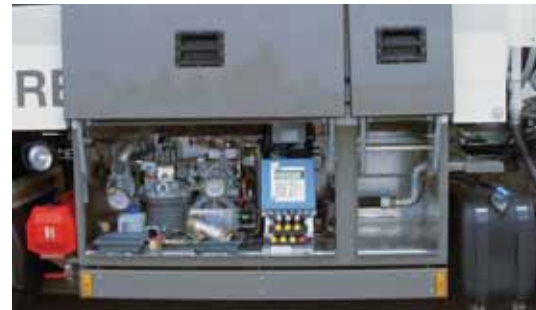
Hochgesetzter Armaturenschrank mit separatem Gebindeabteil.
