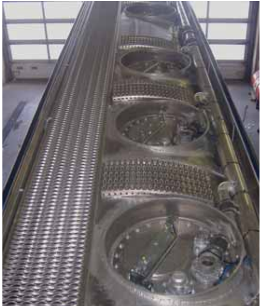
Domarmatur nach EN 13317 / EN 13094 mit Sicherheitslaufsteg und Querlaufstegen.
