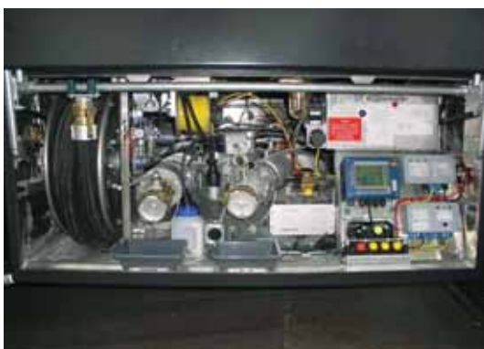
Schwerkraft-Abgabearmatur gemessen und ungemessen mit QSS sowie Gaspendelschlauchtrommel.
