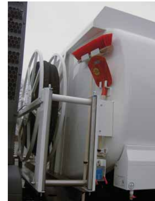
Radialschlauchtrommel freistehend mit Bedienungselementen links und rechts. Optimale und schnell zugängliche Anbringung der GGVS-Ausstattung – Schaufel und Besen – am Behälterboden.
