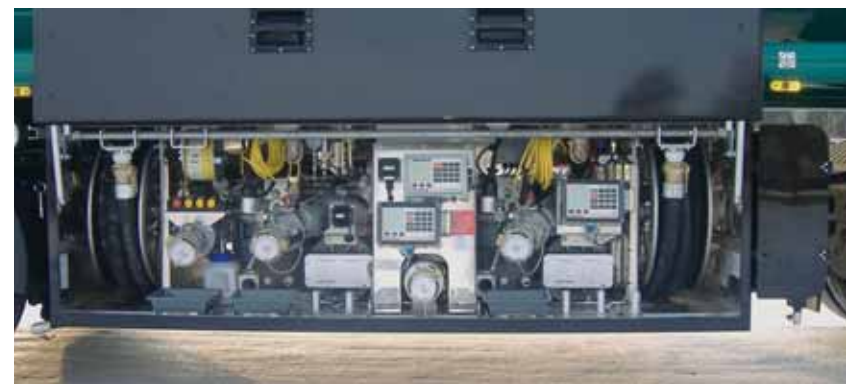
Doppelmessanlage mit QSS und ANA, zwei Gaspendelschlauchtrommeln und Querschlauchrohre.
