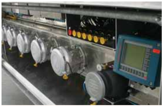
Befüllseite eines TSA mit elektronischem Peilstabsystem - 6-kammrig.
