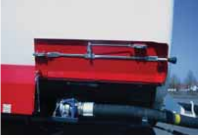
In der Seitenblende integrierte bedienerfreundliche Lagerung des Anhängerverbindungsschlauches.
