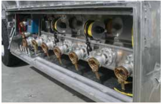
Abgabeseite eines TSA mit elektronischem Peilstabsystem - 6-kammrig.
