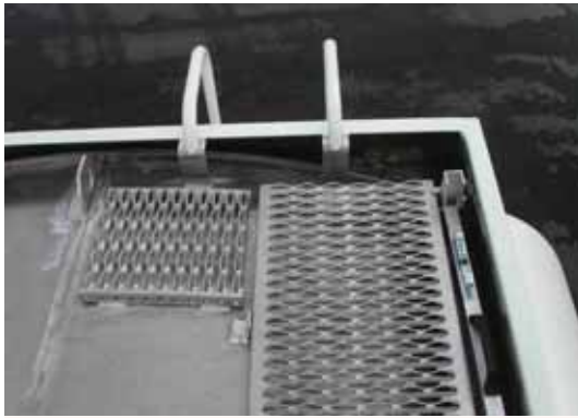
Aufstieg mit Sicherheitslaufsteg und Klappgeländer.
