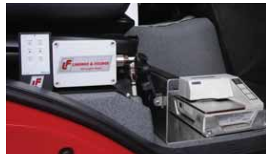
Drucker und L&F 8-Kanal Funkanlage im Fahrerhaus.
